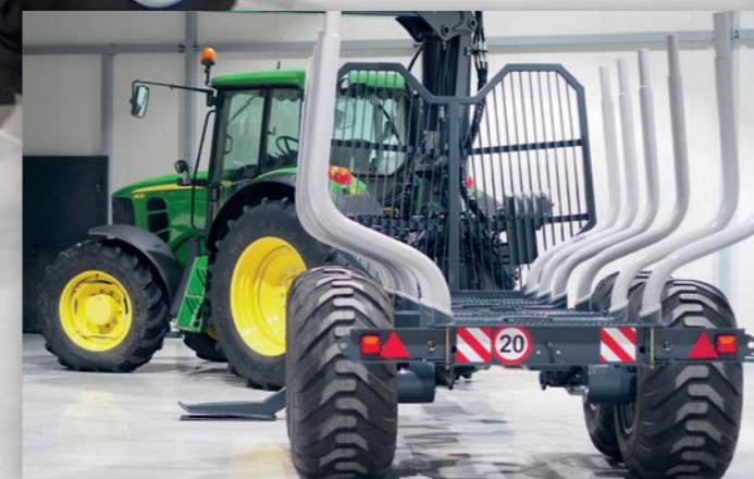
Stabiles Prallgitter mit guter Sicht auf die Ladefläche
