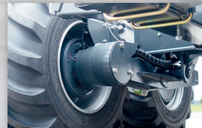
Black bruin 5 - 1600 ccm Radnabenmotor, 2/4 Stück 0 - 6 km/h
